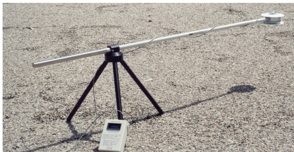
Pyranometer (ASTM E1918, LBNL E1918A)
